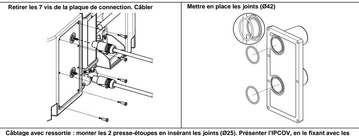
Câblage avec ressortie : monter les 2 presse-étoupes en insérant les joints (Ø25). Présenter l'IPCOV, en le fixant avec les nouvelles vis. Serrer les presse-étoupes pour assurer l'étanchéité.
