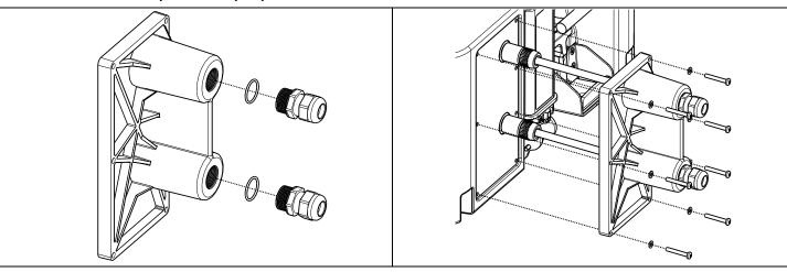
Câblage sans ressortie : monter le presse-étoupe en insérant le joint (Ø25) et le bouchon (M25). Présenter l'IPCOV, en le fixant avec les nouvelles vis. Serrer le presse-étoupe pour assurer l'étanchéité.
